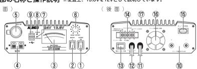
①電源スイッチ :ONで電源が入りOFFで電源が切れます。
