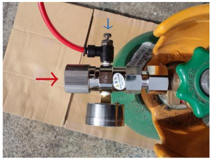
ホースを付けて完了です、赤矢印のバルブは締めて下さい 青矢印のバルブは開いて下さい
