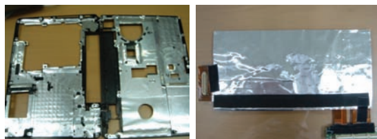
ノート・パソコンのケース内面にAPタイプを付着した例
