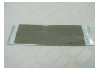
フラット・ケーブルを覆いかぶせて外部からの磁気をシールドしている。
