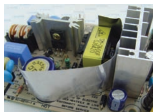
トランスフォーマーから発生する磁気を部分的にシールドしている。
