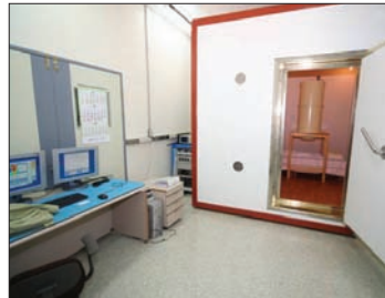
磁気シールド・ルーム
