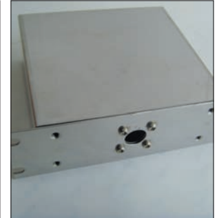
センサーの制御部をシールド筐体に挿入して磁気から防護する。
