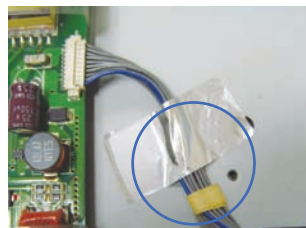
T2801 でインバーター電源ケーブルを固定する。(LCD モニターフレーム)
