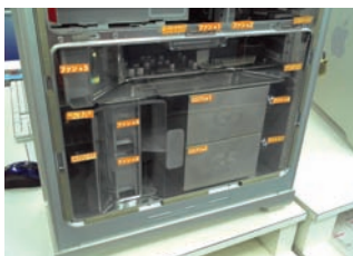
▶コンピューターの筐体とそのカバーの接続部に装着して接地
