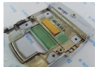
▶携帯電話の内部に接地用でゴールド・ガスケットを付着
